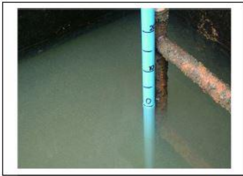
(1) การทำเครื่องหมายที่ท่อพีวีซี
