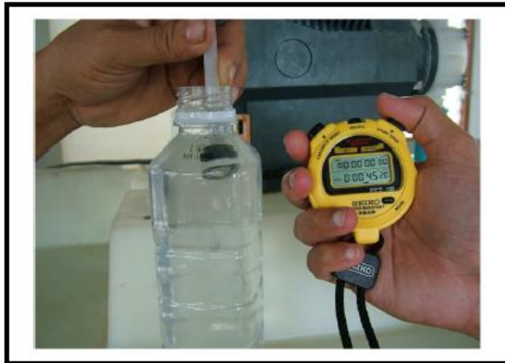
รูปที่ 30 การหาอัตราการจ่ายสารละลายสารส้มโดยวิธีการตวงจับเวลา
