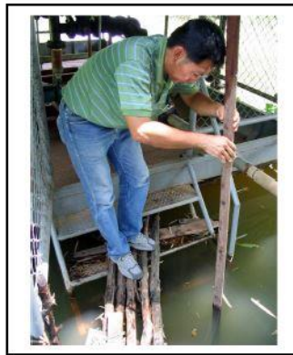
รูปที่ 7 แสดง วิธีการวัดความขุ่นโดยการวัดระยะความลึกจากการมองเห็น
