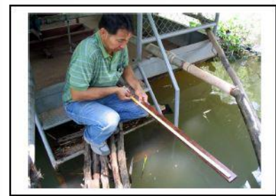
รูปที่ 7 แสดง วิธีการวัดความขุ่นโดยการวัดระยะความลึกจากการมองเห็น
