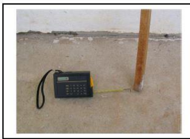
รูปที่ 7 แสดง วิธีการวัดความขุ่นโดยการวัดระยะความลึกจากการมองเห็น
