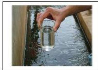
รูปที่ 52 ตรวจสอบน้ำที่ผ่านการกรอง
