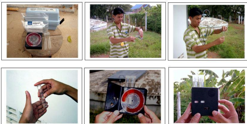
รูปที่ 54 การวิเคราะห์ปริมาณคลอรีนหลงเหลือ โดยวิธีการเทียบสี
